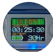
Kodowany kolorami ekran pokazujący pozostały czas pracy akumulatora
