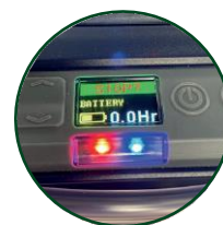
Kolorowy wyświetlacz OLED z niebieską / czerwoną kontrolką sygnalizującą stan pompy, widoczną z daleka.
