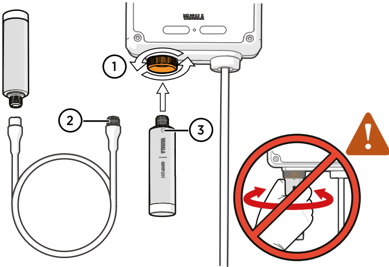
图 26 将探头和电缆连接到 Indigo200
