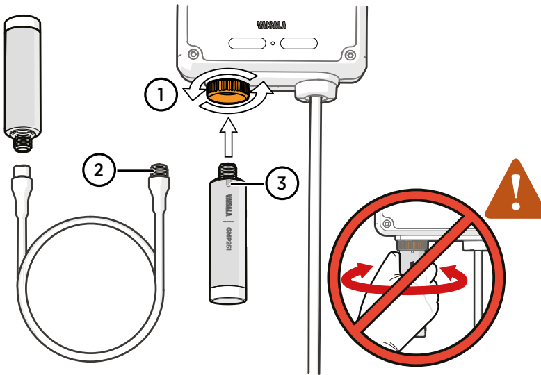
Figura 12 Fijación de sondas y cables a Indigo200
