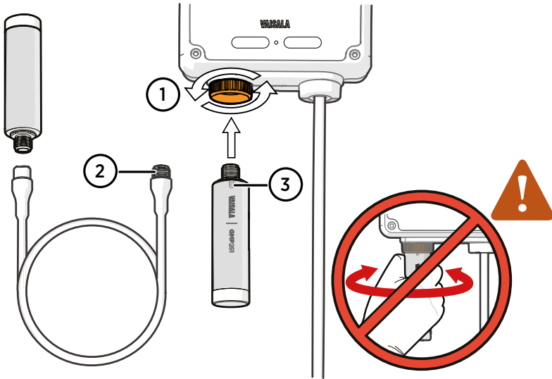
図 19 プローブとケーブルのIndigo200への取り付け
